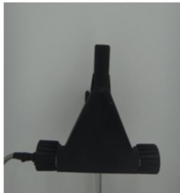
Figuras 3 Sonda do Opacímetro Smoke Check 2000
