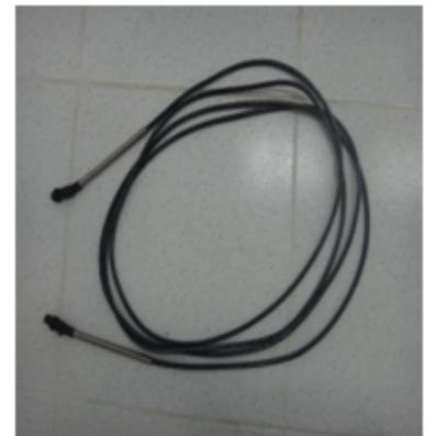
Figuras 4 Cabo do Opacímetro Smoke Check 2000
